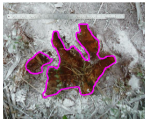
Figura 2. Determinação da área de contato solo-pneu em laboratório com auxílio do software AutoCad 2007.
