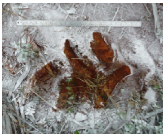
Figura 1. Determinação da área de contato solo-pneu em campo.
